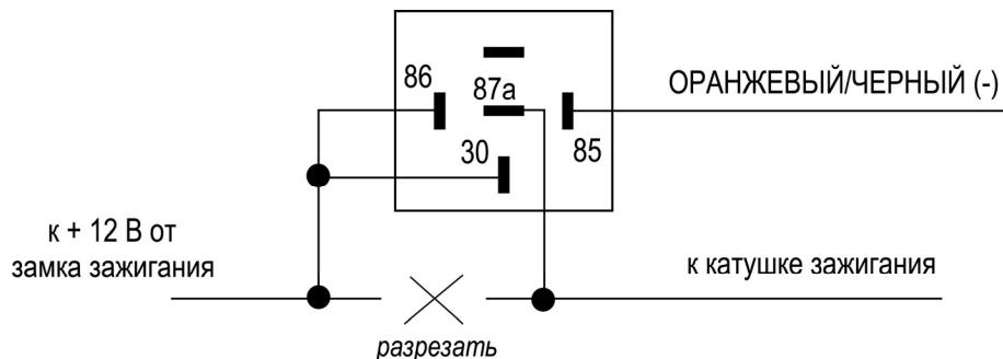
**Примечание:** данная схема может также использоваться для подключения Синего провода системы, для этого Синий провод должен быть запрограммирован как «отрицательный выход при включенном режиме охраны для управления дополнительным Н.З. реле блокировки двигателя» (программируемая функция # 17).
