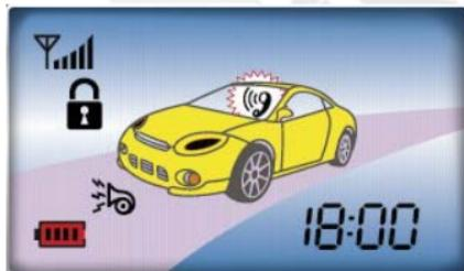
При необходимости вызова владельца автомобиля поступите твердым предметом (монета, ключи и т. п.) дважды в течение 1,5 сек. вблизи датчика вызова. Светодиод датчика вызова засветится синим цветом на 3 сек., если система в этот момент находится в режиме охраны. Функция вызова владельца автомобиля доступна в любом
