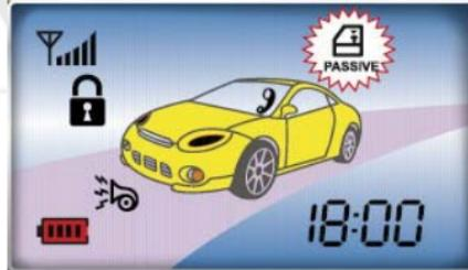
Если выбрано значение 4 программируемой функции 1-5, (см.стр.87), то система в режим охраны не встает, а только включает блокировку стартера (зажигания) по истечении 30сек. после выключения зажигания или по завершении режимов резервирования запуска, «Short Stop» и «Турбо». Для выключения блокировки стартера (зажигания) в этом случае необходимо кратковременно нажать кнопку II брелока.
