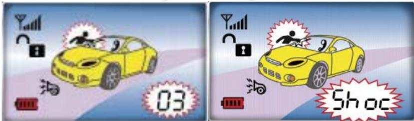
Если в режиме охраны система срабатывала только от датчика вызова владельца, то при снятии с охраны система сообщит об этом миганием символа на дисплее брелока, надписью «CALL» и указанием числа срабатываний.
