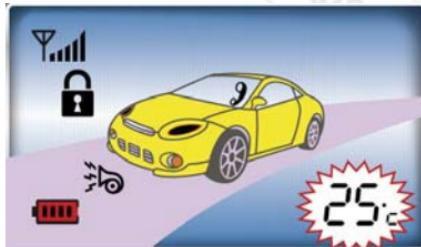
При проверке состояния системы индикация текущего времени сменяется значением температуры в салоне автомобиля. Температура может отображаться в °C или °F (см. стр. 18).
