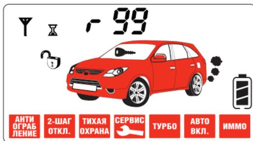
если запрограммирован режим турботаймера, то отобразятся иконки **r 01**, **r 02**, **r 03** или **r 04**
