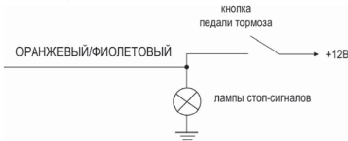
В автомобиле с *ручной* коробкой передач подсоедините Оранжевый/Фиолетовый провод к проводу, замыкающемуся на массу при взведении ручного тормоза:
