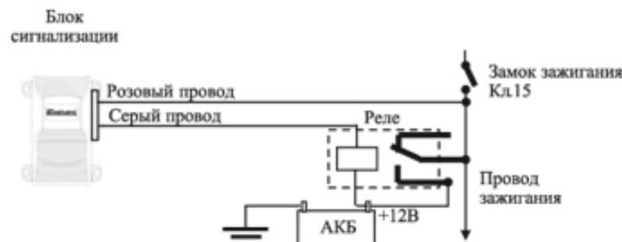
**Подключение нормально разомкнутого реле блокировки**
