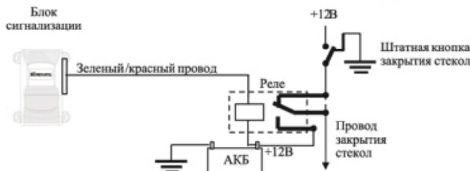
**Подключение дополнительного канала 1 для реализации функции “Поддержка зажигания”**
