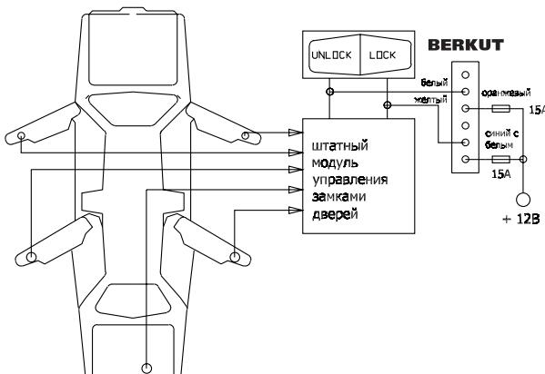
При установке системы в таких автомобилях (большинство легковых автомобилей марки «Дженерал Моторс») темно-зеленый и темно-синий провода запирания/отпирания дверей автомобиля не используются.
