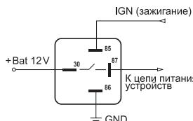
Схемотехника реле обеспечивает его работоспособность в любых вариантах подачи питания на контакты реле. В случае, когда невозможно обеспечить постоянное питание реле по цепи коммутации, 30 сек задержка автоматической постановки на "ОХРАНУ" (ARM) не выполняется. В этом случае состояние "ОХРАНА" (ARM) наступает сразу при включении зажигания или подаче питания на реле.
