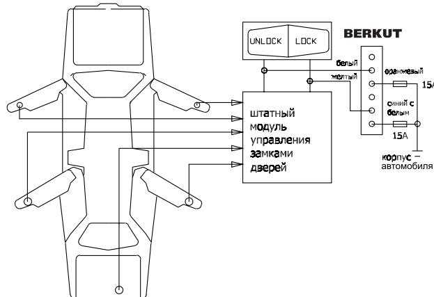
При установке системы в таких автомобилях (большинство автомобилей японского производства) темно-зеленый и темно-синий провода запирания/отпирания дверей автомобиля не используются.
