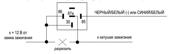
*Примечание:* При использовании Синего/Белого провода для реализации данной функции - выход системы уже более не будет замыкаться на "массу" при нажатии кнопок
