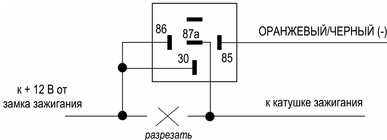
**Примечание:** данная схема может также использоваться для подключения Синего провода системы, для этого Синий провод должен быть запрограммирован как «отрицательный выход при включенном режиме охраны для управления дополнительным Н.З. реле блокировки двигателя» (программируемая функция # 17).
