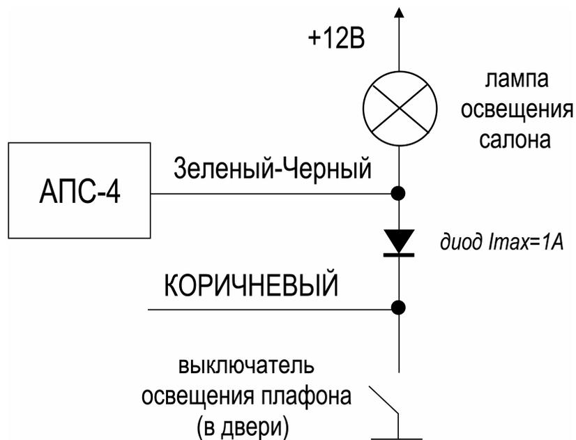
2. Рекомендуемая схема подключения Коричневого провода системы ("отрицательный триггер двери") к проводке автомобилей ВАЗ семейств 2110 и 2115, оснащенных иммобилайзерами АПС-4:
